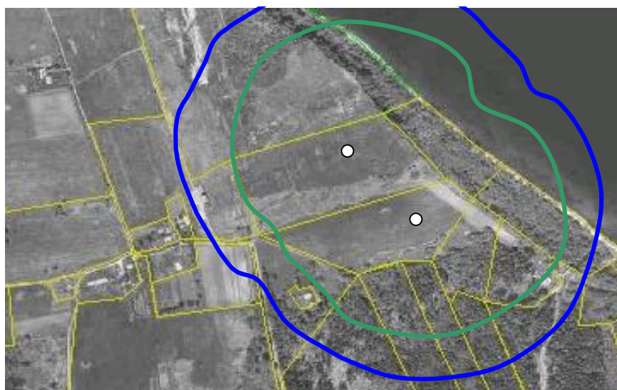
Joonis 6. Tuulepargist lähtuv 40 dB(A) ületav müra A alternatiivi puhul.
